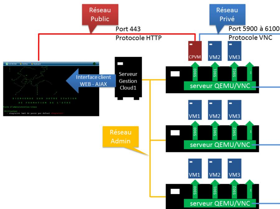
Figure 22 Principe de fonctionnement de la CPVM
