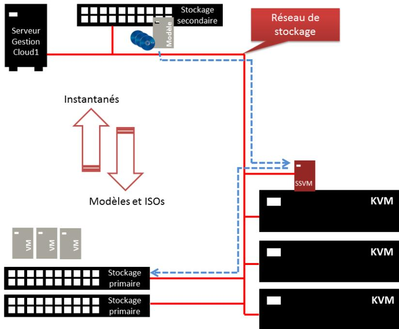
Figure 23 Principe de fonctionnement de la SSVM
