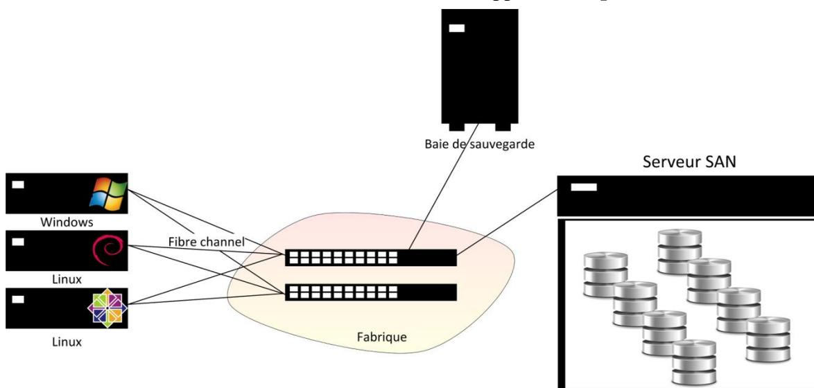
Figure 53 Schéma de fonctionnement d'un SAN
