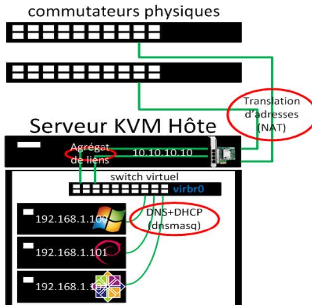
Figure 19 Schéma de fonctionnement d'un commutateur virtuel
