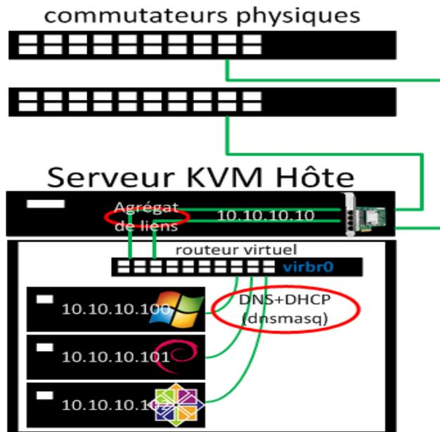
Figure 20 Schéma de fonctionnement d'un routeur virtuel
